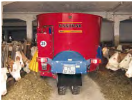
Kompakte Bauweise und beidseitiger Austrag ohne Überfahren des Futters.
